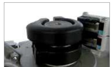
Mechaniczne ograniczniki krańcowe z precyzyjną regulacją
