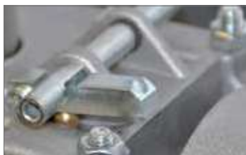
Zewnętrzne wysprzężenie dla ręcznego odblokowania
